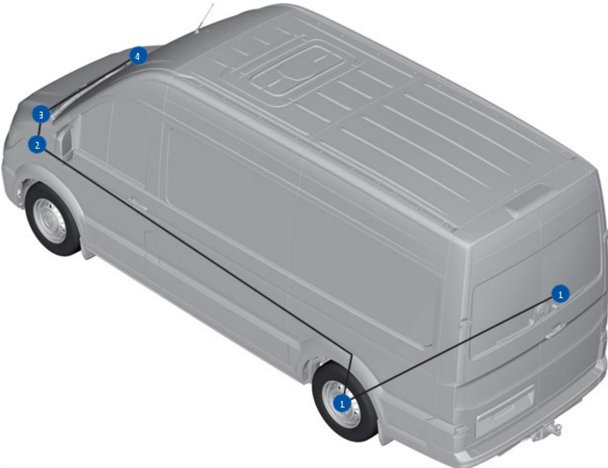
1. Raddrehzahlsensor Heckantrieb
